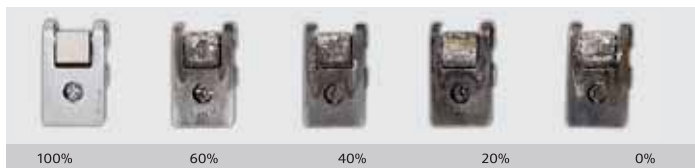
FOTO 6.2 DESGASTE DOS CONTADORES
