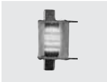
FOTO 2.7 FUSÍVEL NH EM CURTO-CIRCUITO
